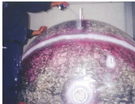
Fig. 5.6 Aplicación del revelador para la detección de alguna anomalía al equipo.
