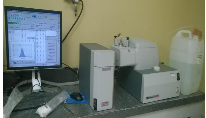
Figura No. 14.- Equipo Microtrac, usado para medir el tamaño de
