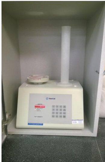
Figura No. 16.- Tap Density, equipo utilizado para determinar que tan compacto es el mineral
