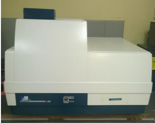
Figura No. 13.- Equipo Cilas, utilizado para medir el tamaño de partícula
