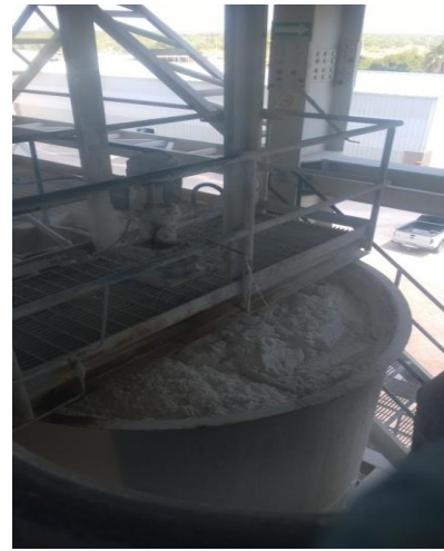
Figura No. 6- Proceso de flotación inversa, en el que la calcita se encuentra en la parte superior
