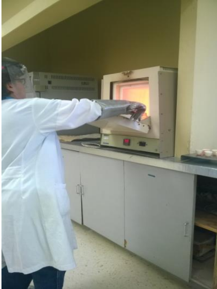
Figura No.9.- Prueba de pérdida por ignición en mufla a 887°C
