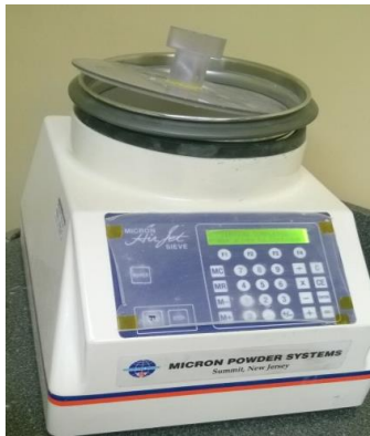
Figura No. 15.- Equipo Air Jet, utilizada para medir la finura del material
