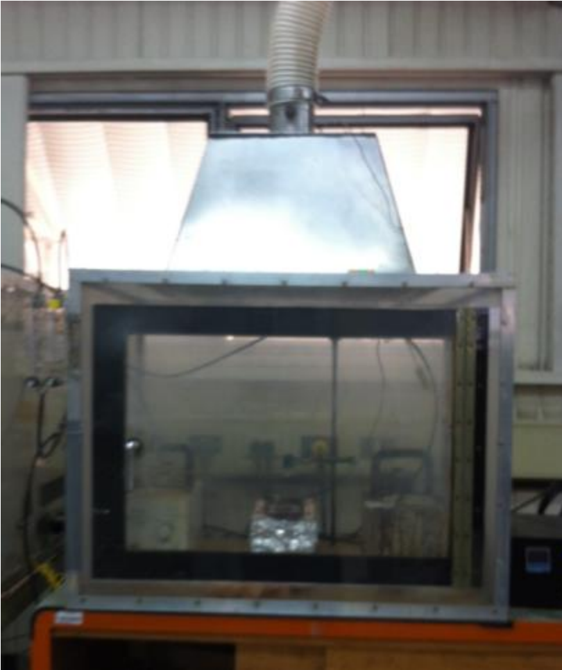
Fig. 3 Campana de extracción, en su interior se encuentra los humidificadores ultrasónicos.
