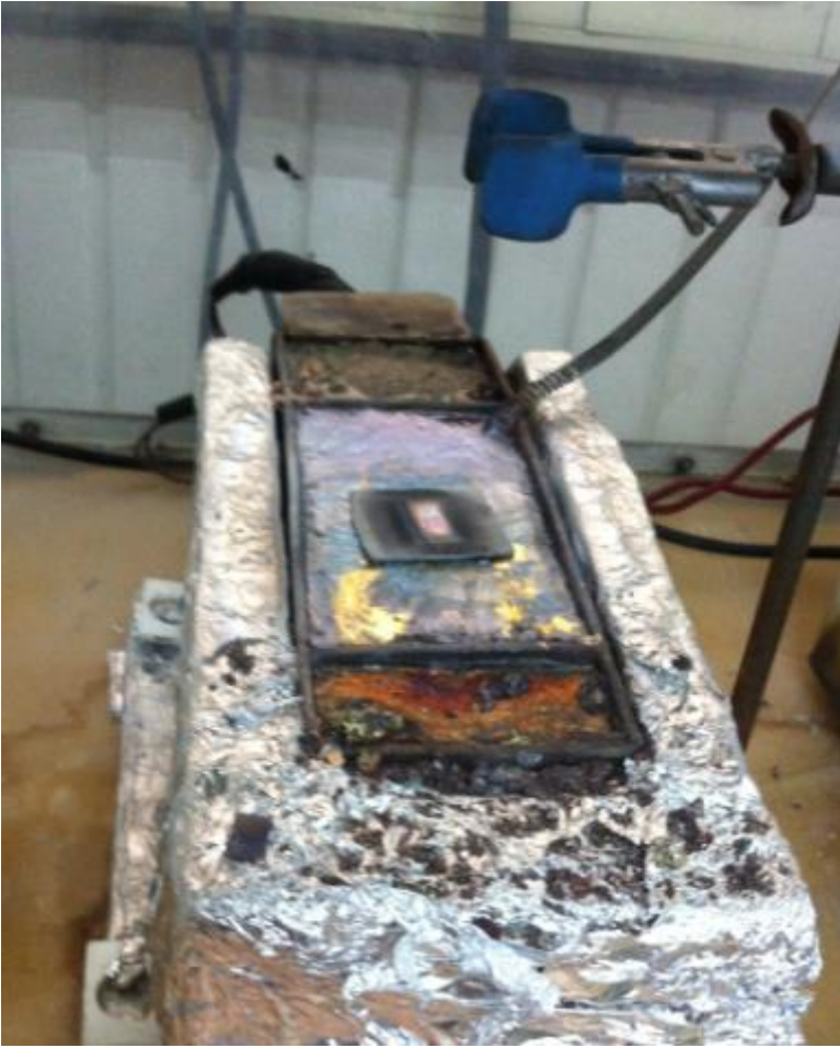
Fig. 2 Baño de estaño con sustrato de silicio incorporado y sustrato de vidrio encima.
