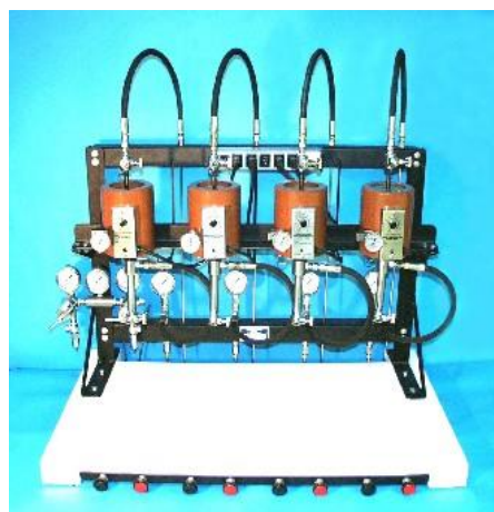
Fig. 10 Batería de filtros prensa con sistema de presurización portátil.
