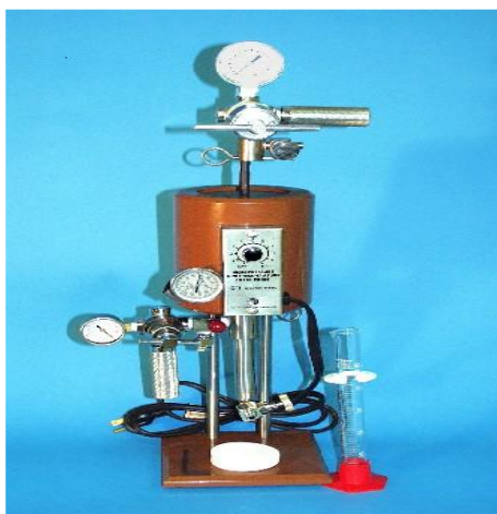
Fig. 9 Filtro prensa con manómetros de presurización portátiles y probeta colectora de filtrado.
