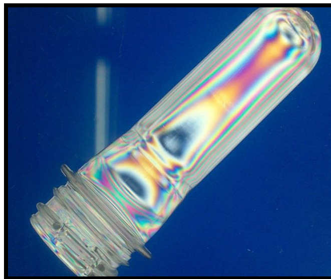
Imagen 7.2-3: Preforma 45° de inclinación luz polarizada.
