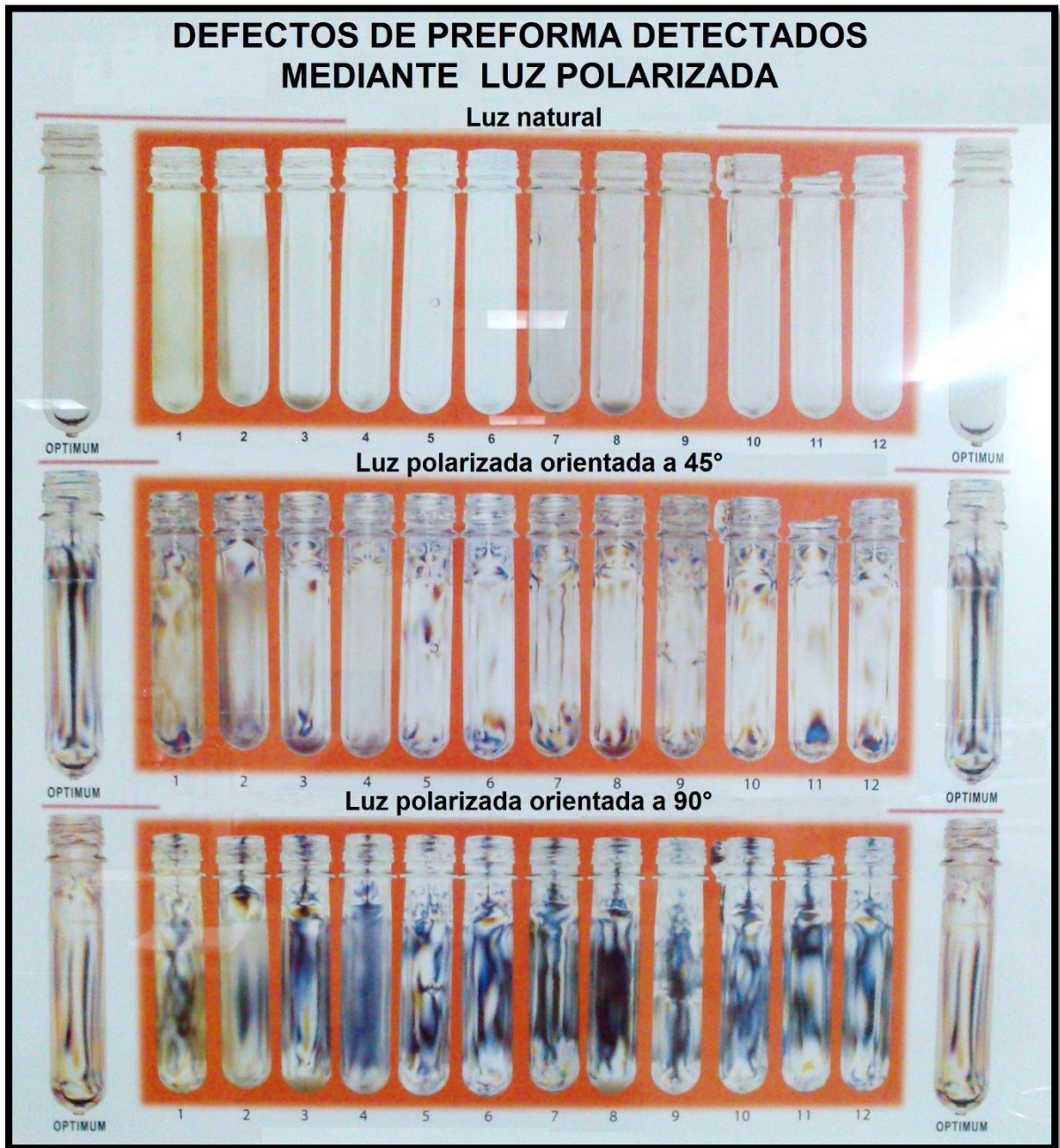
Imagen 7.2-4: Tablero de identificación de defectos de preformas.
