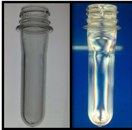
Imagen 7.2-1: Preforma en luz natural y luz polarizada, respectivamente.
