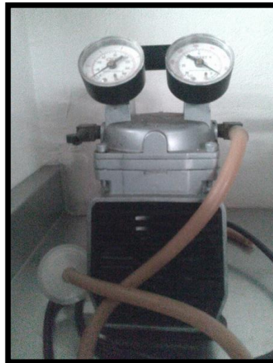
Imagen 7.1.5-2: Bomba de vacío.
