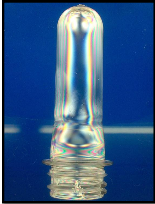
Imagen 7.2-2: Preforma 90° de inclinación luz polarizada.
