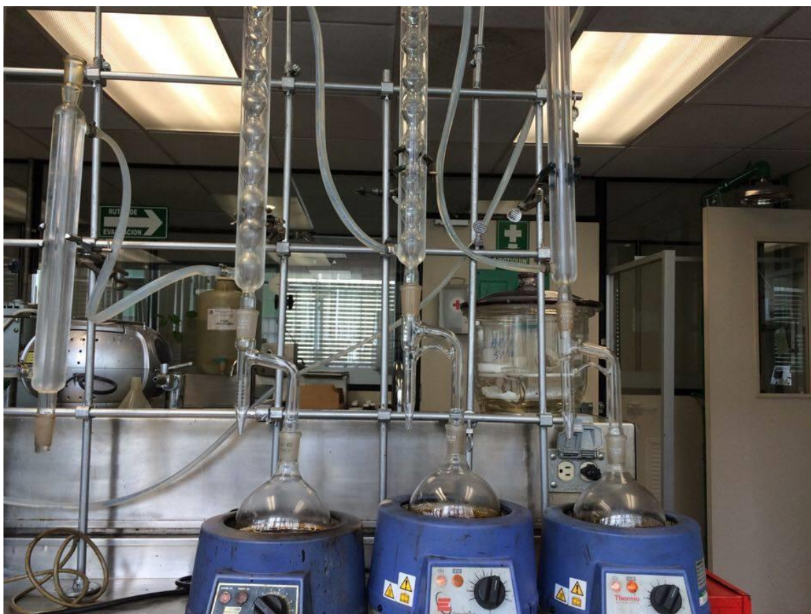
Figura 3. Equipo de destilación para agua en aceites crudos.
