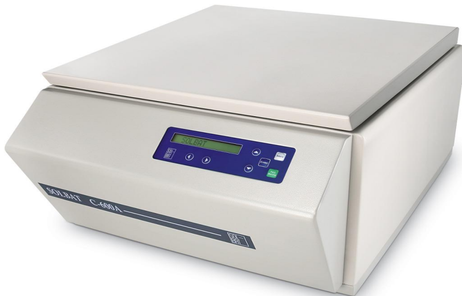
Figura 4. Centrifuga para la prueba de agua y sedimento en crudo.
