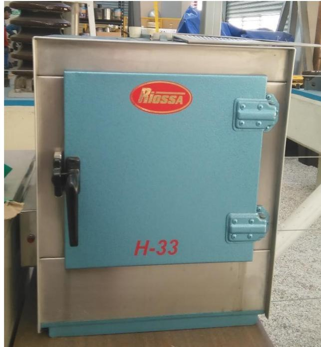
Figura 32. Horno de secado para el calentamiento de aceite
