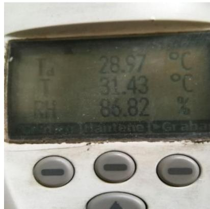
**Figura 29. Datos de los parámetros del Sensor Vaisala después de las 18 horas de estabilización**
