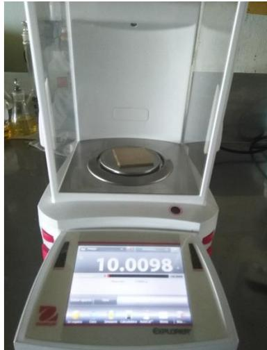
**Figura 30. Balanza analítica para la medición de masas de *pressboard* y papel Manning**
