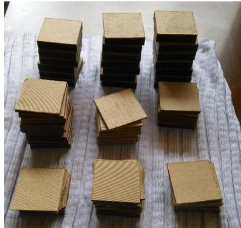
Figura 26. Segmentos de Pressboard T4 y H1V2 de 5 x 5 cm
