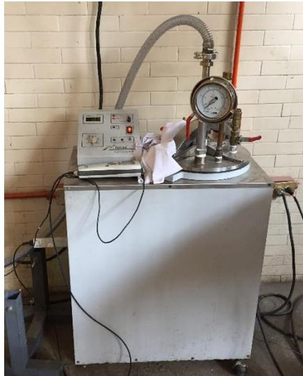
**Figura 28. Autoclave para el secado de pressboard**
