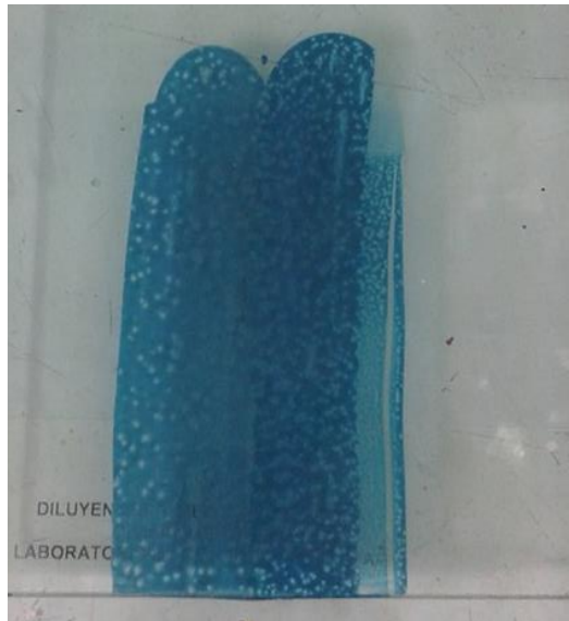
Imagen 1. Barrido de pintura amartillada
