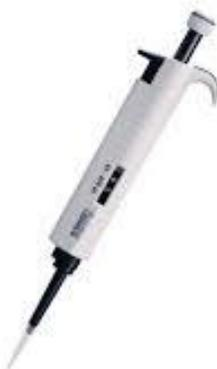
Fig. 11.1 Micropipeta.
