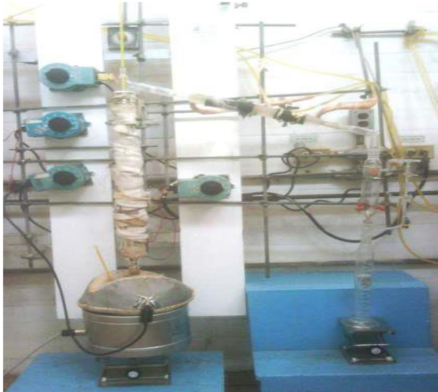
Fig. 5 Equipo para la destilación a vacío
