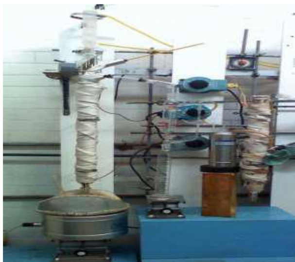
Fig. 3 Equipo de destilación técnica a presión atmosférica
