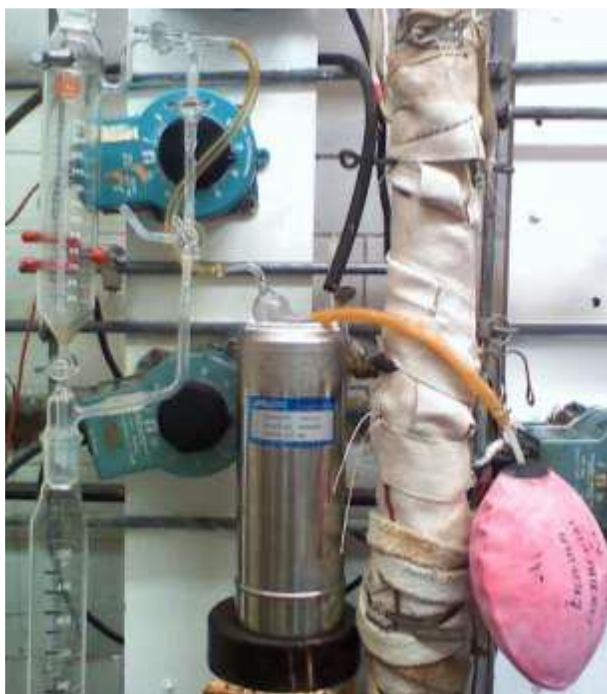
Fig. 4 Trampa de incondensables y gas licuado
