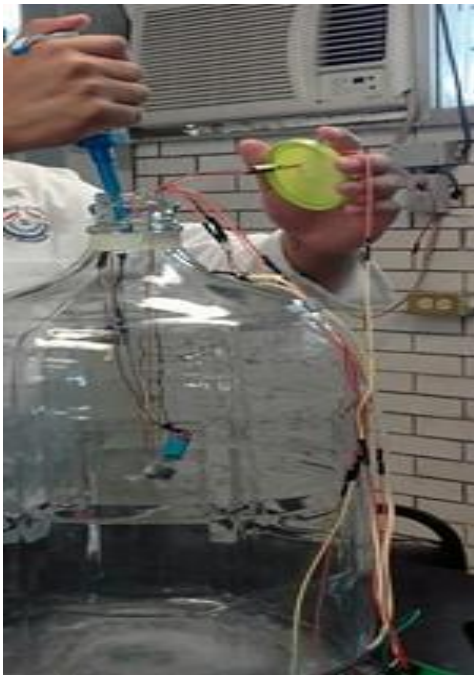
Figura 10 Calibración del sensor MQ-135 a diferentes concentraciones.
