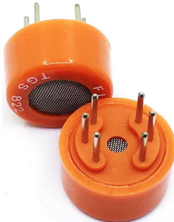
Figura 4.1 Sensor Fígaro TGS 822 para la detección de tolueno y xileno.
