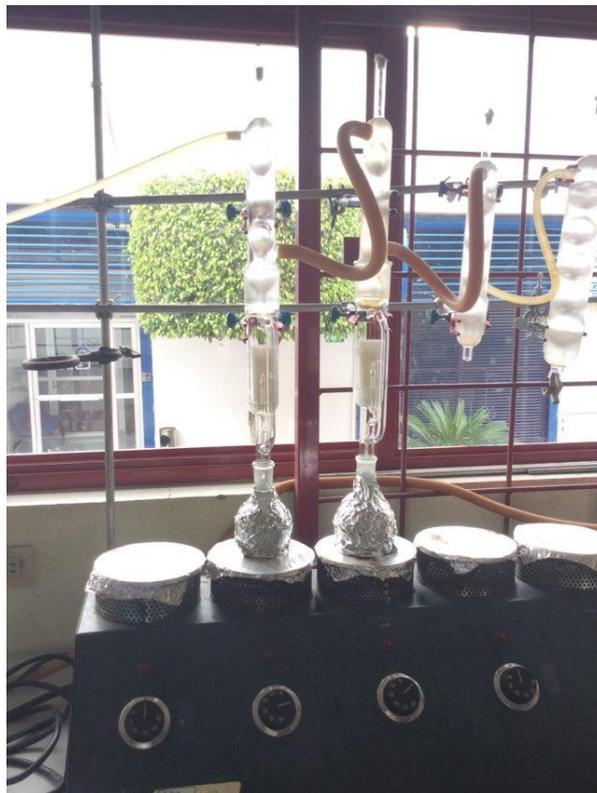
**Figura 18.** Determinación de grasa por método de Soxhlet producto final
