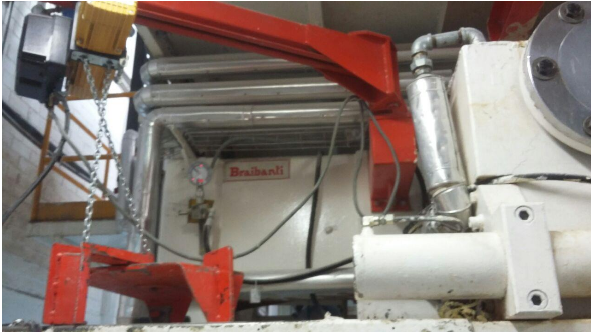
3. Gancho elevador de moldes para cambio de formato.
