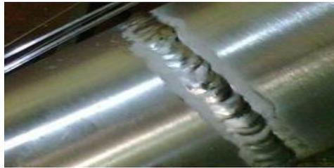
Fig.3.11. Soldadura de acero inoxidable.
