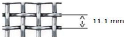
Figura 3.7 Medida de la malla en la base de la bandeja
