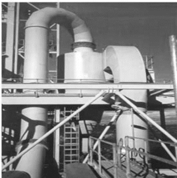
*Figura 3.3 Horno deshidratador vertical.*
