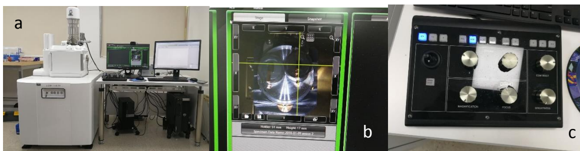
Figura 15. Microscopio electrónico de barrido y sus partes; a) Microscopio SEM con EDS, b) selector de muestra y c) controles.
