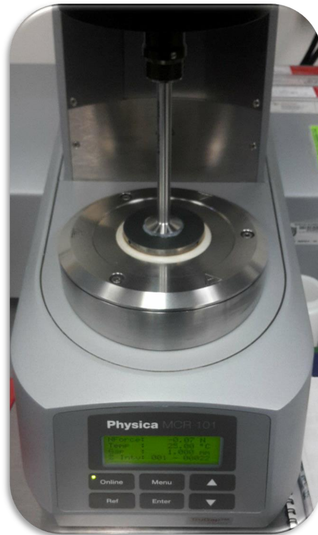
Geometría de platos paralelos modelo PP25/S
