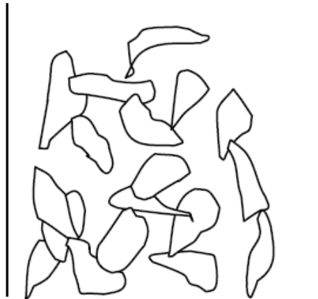
Figura 3.10: Fase dispersa tipo Card House o “Castillo de cartas”
