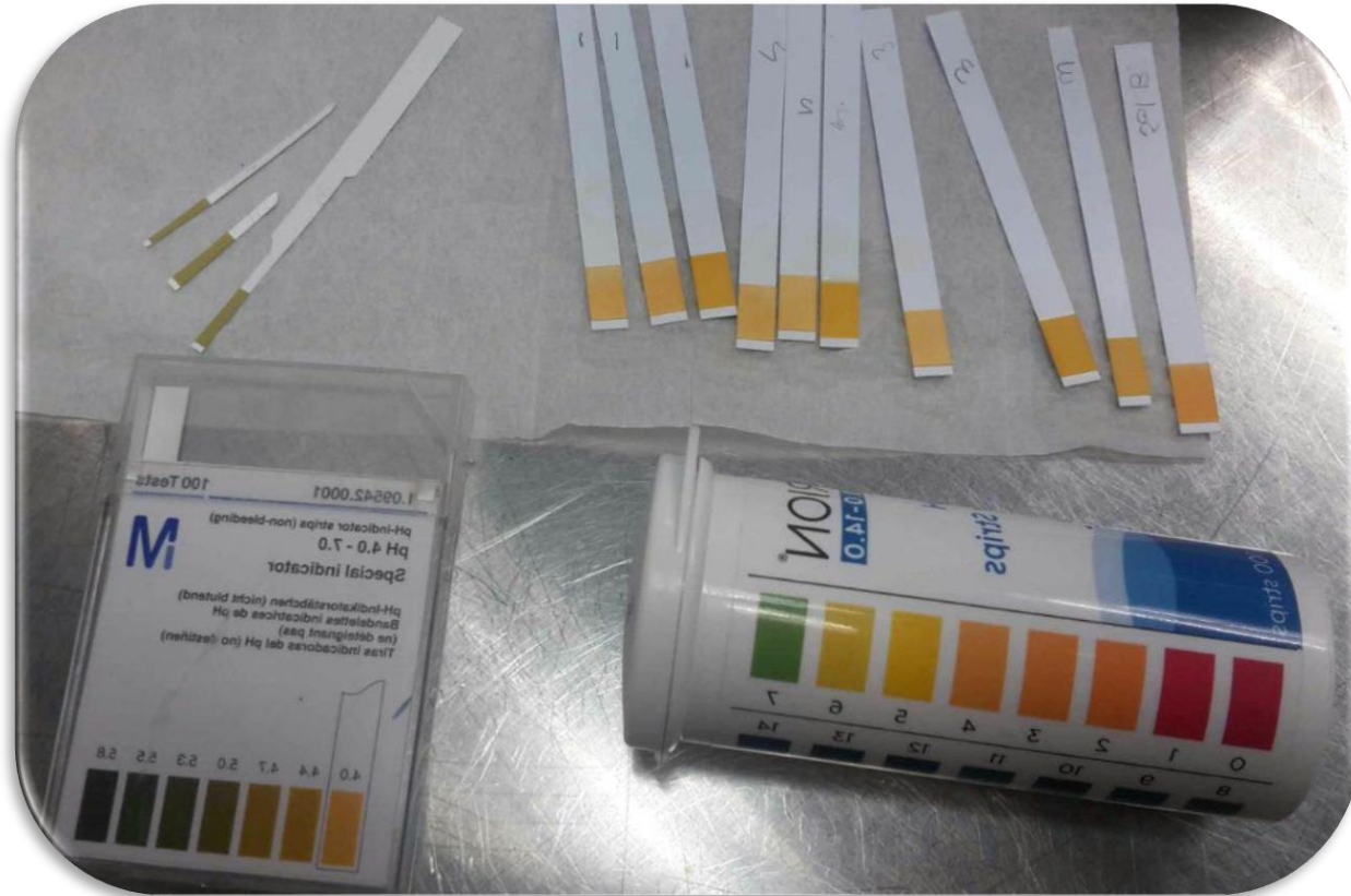
Tiras de pH de las 3 soluciones y solución buffer
