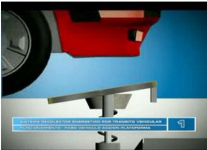
Con este movimiento descendente se activa un mecanismo de cuatro barras que hace que el engrane gire y genere energía mecánica
