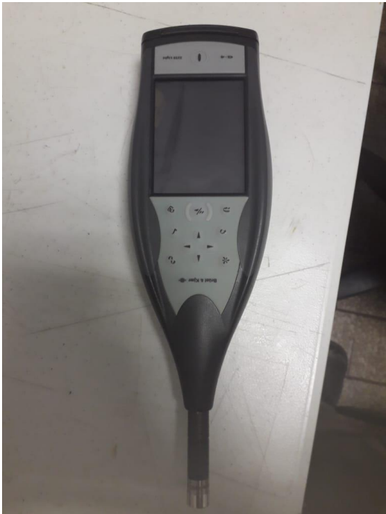
Sonómetro, instrumento para la medición del ruido.
