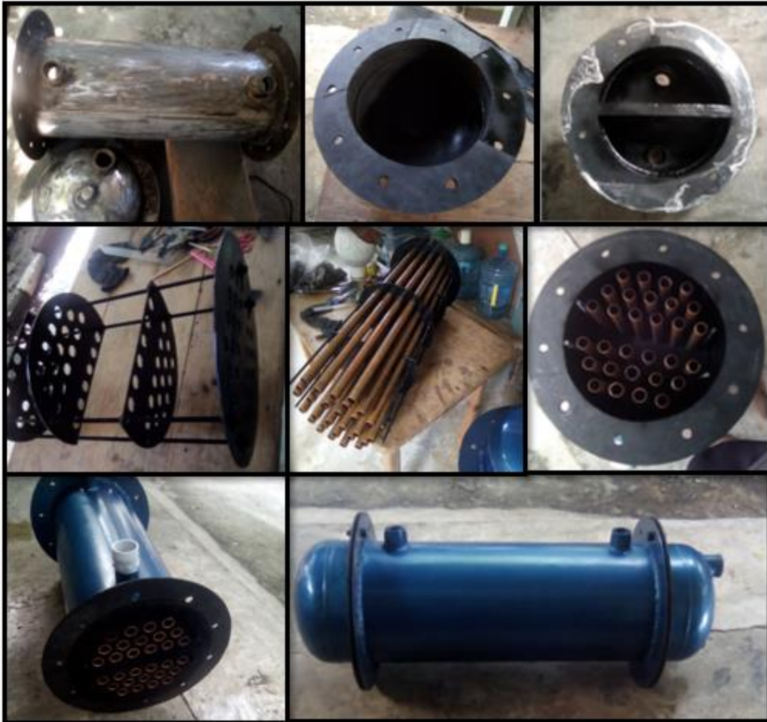
Figura 4.15. – Cronograma de la tercera parte de la construcción; limpieza del prototipo, aplicación de pintura protectora, y ensamble de las partes del haz de tubos.
