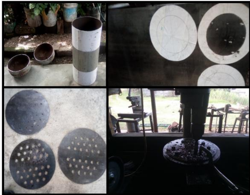
Figura 4.13. – Cronograma de la primera parte del proceso; corte del cilindro de gas con las tapas removidas, deflectores dibujados en la lámina, y perforación de las placas porta tubos y baffles.
