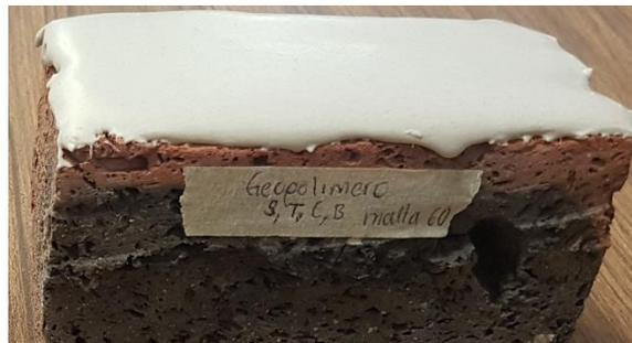
Fig. 4.1.1 Geopolímero con tamaño de partículas correspondiente a Malla tyler 60, después de 7 días de secado.
