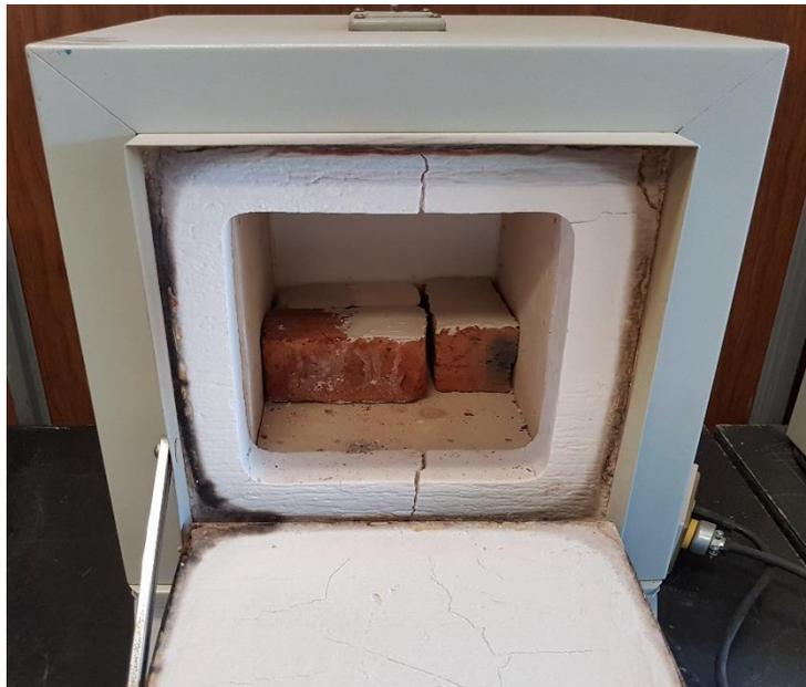
Fig. 3.4.3.1 Mufla FELISA FE-360 para quemar las probetas de ladrillo con geopolímero.
