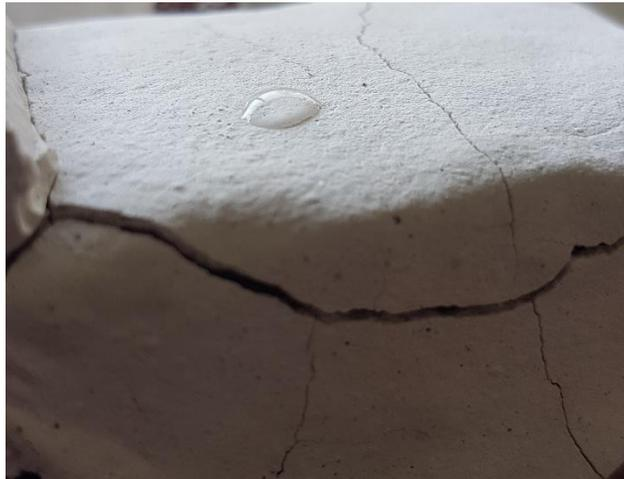
Fig. 4.3.1 Geopolímero con tamaño de partícula correspondiente a malla 60 sometido a prueba de absorción.
