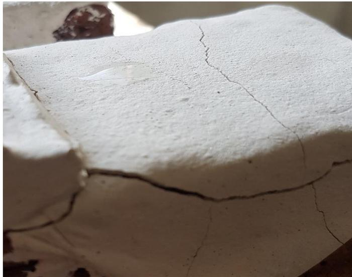
Fig. 4.2.2 Geopolímero quemado prueba número 2 con tamaño de partícula correspondiente a malla 60 con una fractura y algunas fisuras menores.
