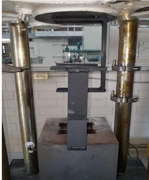
Dispositivo para prueba de adherencia solera de 2,3/8 " acero coll rolled.
