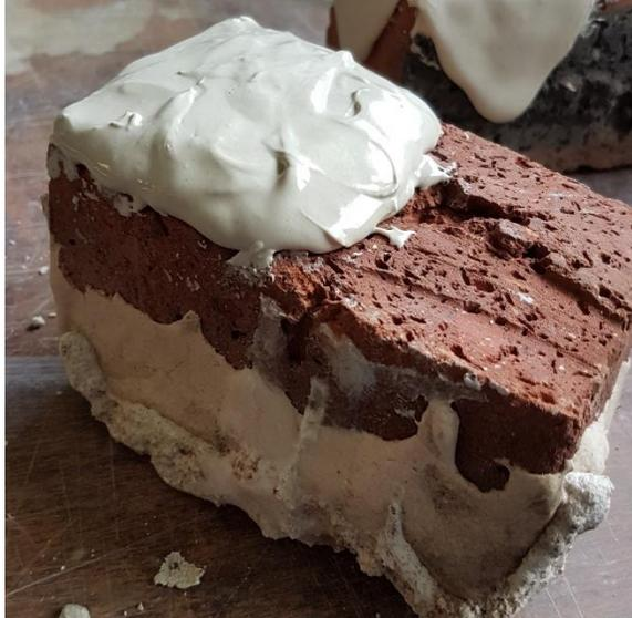
Fig. 3.4.3 Aplicación de Geopolímero en una de las probetas de ladrillo rojo.
