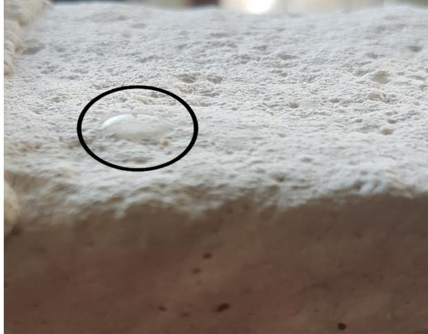
Fig. 4.3. Geopolímero con tamaño de partícula correspondiente a malla 30 sometido a prueba de absorción.
