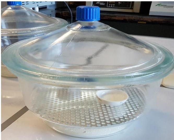
Fig. 3.6.3 Desecador con muestra de arcilla Bauwer reposando para análisis SEM.
