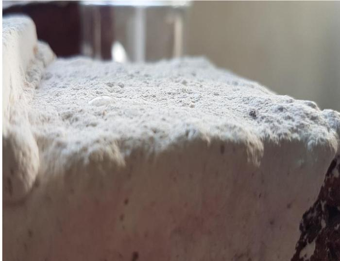
Fig. 4.2.1 Geopolímero quemado probeta número 2 con tamaño de partícula correspondiente a malla 30, sin ninguna fisura o fractura.
