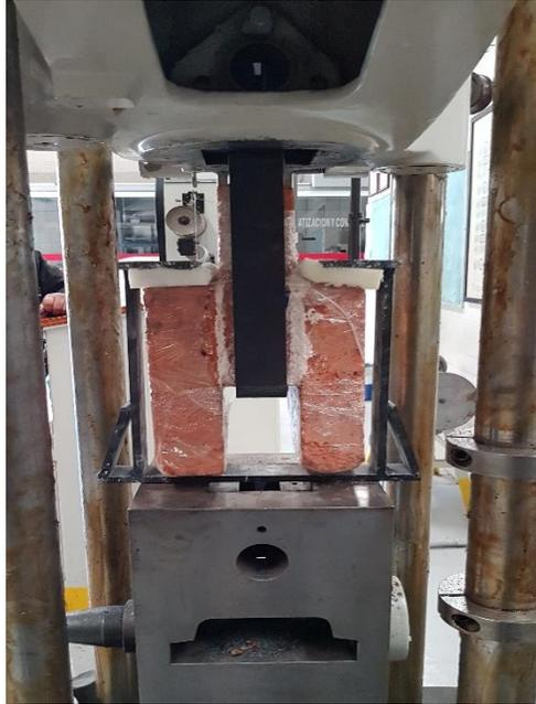
Como podemos observar el gancho central es el único que tendrá movimiento hacia arriba provocando la tensión, y los laterales permanecerán fijos en la mordaza que se aprecia en la figura.
