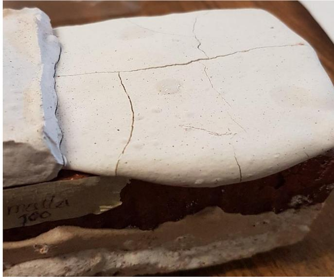
Fig. 4.2.3 Geopolímero quemado probeta número 2 con tamaño de partícula correspondiente a malla 100 presentando leves fisuras y dos fracturas.
