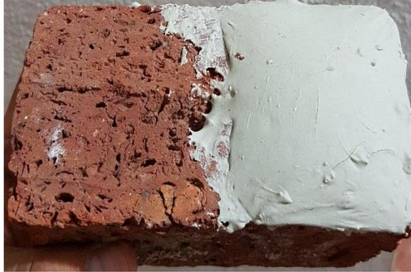
Fig. 4.1.2 Geopolímero con tamaño de partículas correspondiente a malla Tyler 100, después de 7 días de secado.
