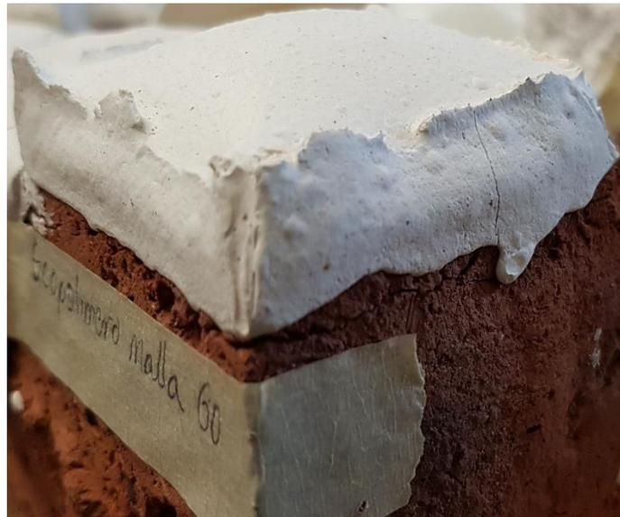
Fig. 4.2.4 Replica Geopolímero quemado probeta número 3 con tamaño de partícula correspondiente a malla 60, con fisura.
