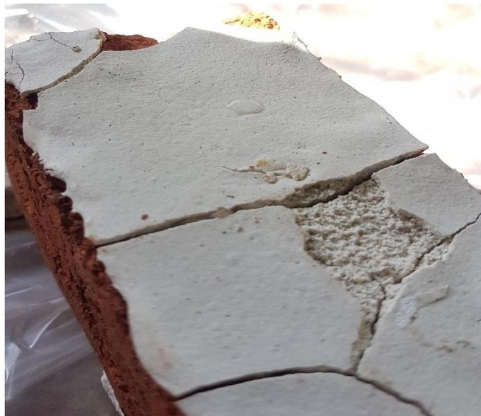
Fig. 4.2 Geopolímero quemado, probeta número 1, con tamaño de partícula correspondiente a malla 100 presentando evidentes fracturas.
