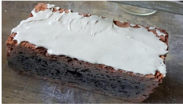
Fig. 4.1 Se aprecia la aplicación del geopolímero como cubierta de la probeta.
