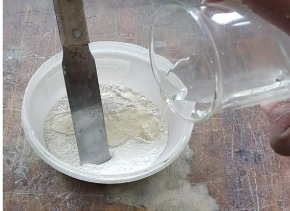
Fig. 3.4.2 Mezclado de las arcillas Tepozán, Caolín, Bauwer con Silicato de Sodio comercial.
