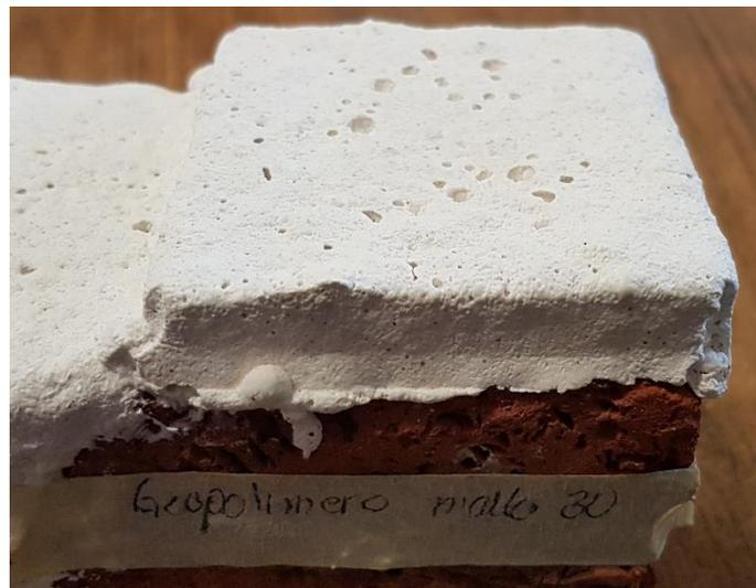
Fig. 4.2.6 Replica Geopolímero quemado probeta número 3, con tamaño de partícula correspondiente a la malla 30 sin ninguna fisura o fractura.
