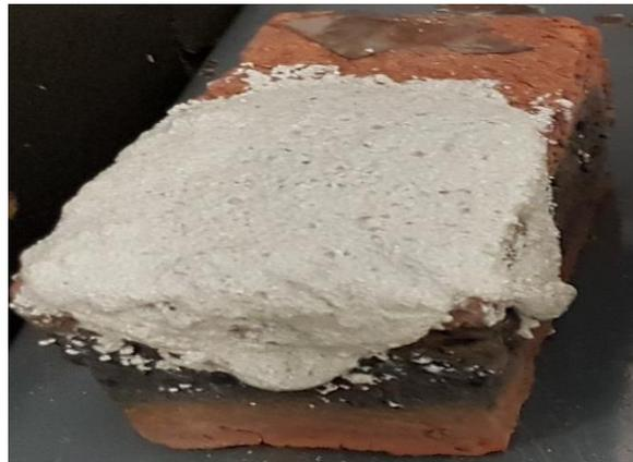
Fig. 4.1.3 Geopolímero con tamaño de partículas correspondiente a Malla Tyler 30, después de 7 días de secado.
