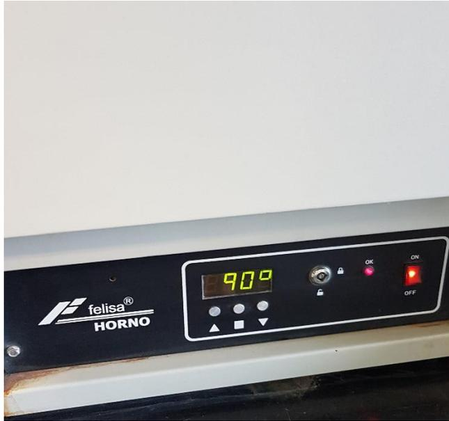
Fig. 3.6.1 Horno FELISA configurado a 90 °C por 4 horas para extraer el exceso de humedad que afectaría el análisis SEM.
