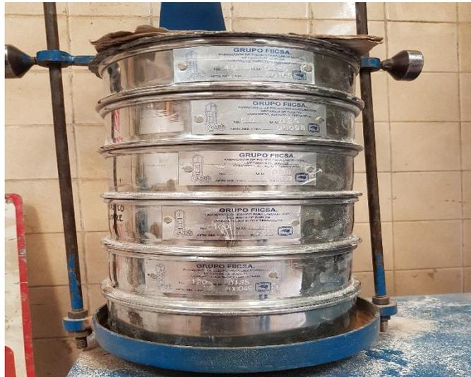
Fig. 3.3 Tamizado de arcillas para obtener medidas de malla 30, 60, 100. Después del proceso de trituración y molienda.
