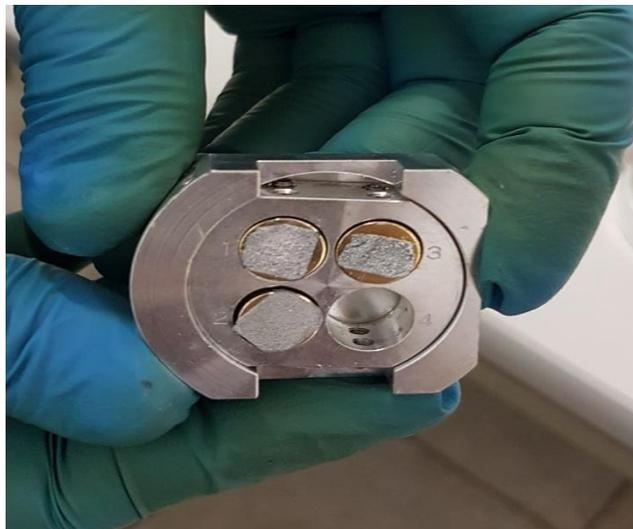
Fig. 3.6.6 Pines colocados en la porta pines con las muestras de arcilla para realizar el análisis SEM.
