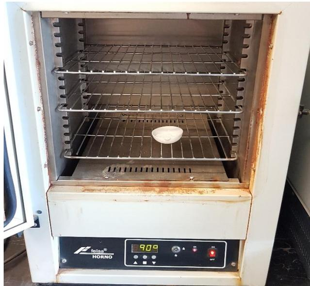
Fig. 3.6.2 Arcilla Bauwer dentro del horno FELISA antes de iniciar el proceso de secado.
