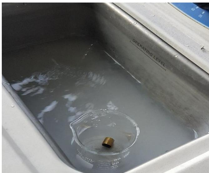
Fig. 3.6.4 Pines de cobre en presencia de un solvente sometidos a un baño ultrasónico.
