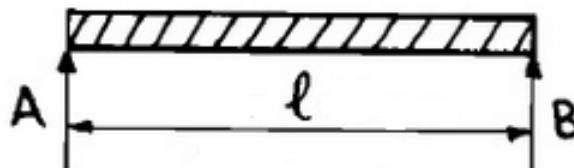
Figura 3. 10 Viga Simplemente Apoyada Y Con Carga Uniforme
