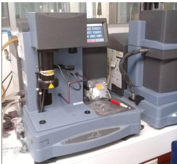
**Figura 32.** Equipo de termogravimetría.
