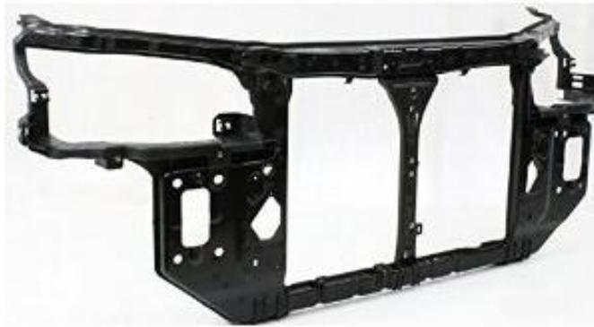
**Figura 14.** Soporte de radiador de Nylon 6.
