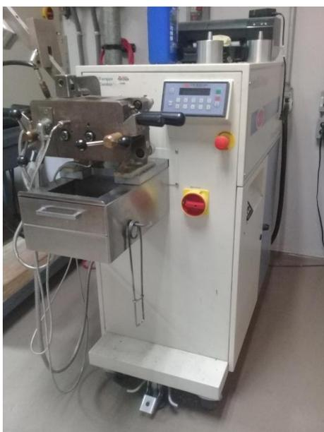
**Figura 19.** Mezcladora por fundido marca Brabender.
