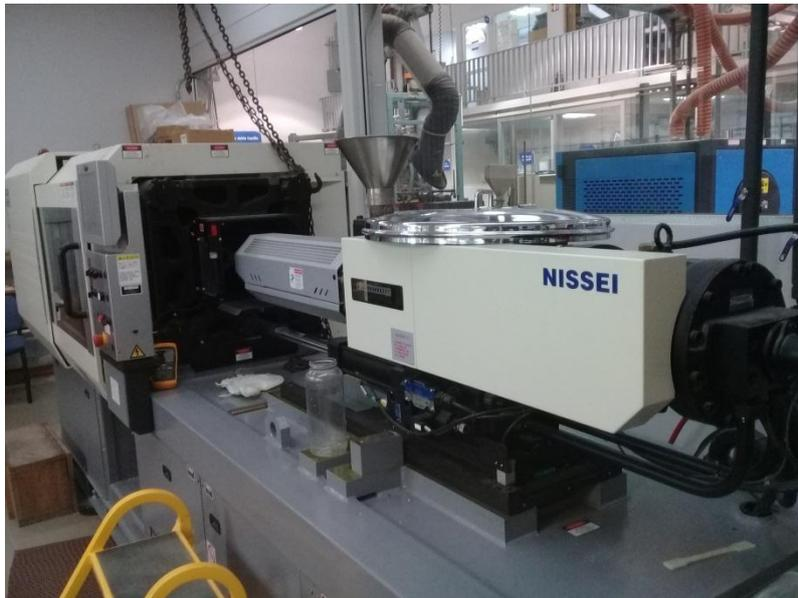
**Figura 23.** Máquina de moldeo por inyección.
