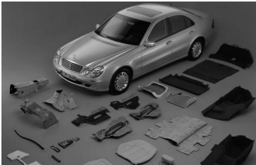
**Figura 17.** Autopartes fabricadas de Lino, cáñamo, sisal, lana y principalmente Nylon 6.
