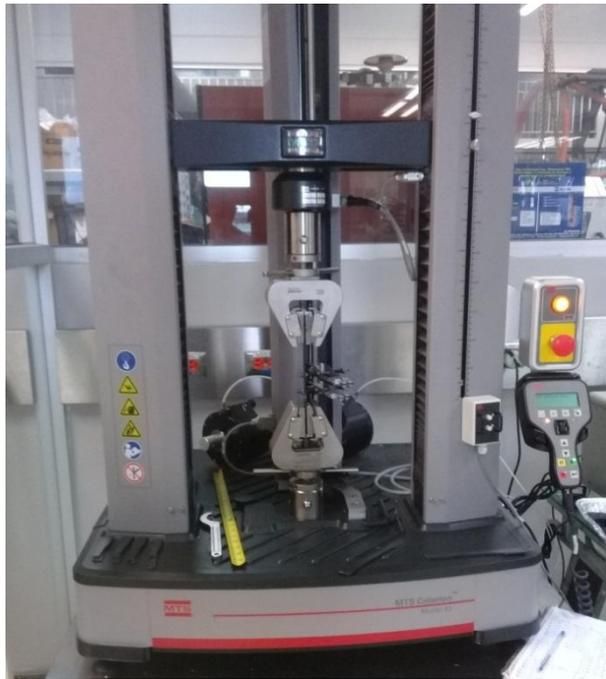
**Figura 28.** Máquina de ensayos universal MTS Criterion.
