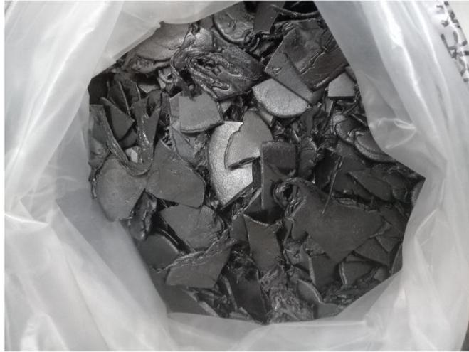
**Figura 21.** Material fundido y prensado.
