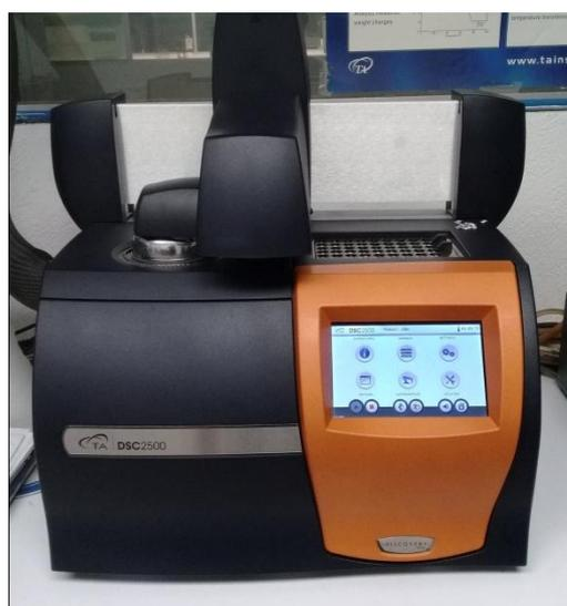
**Figura 33.** Calorímetro diferencial de barrido.
