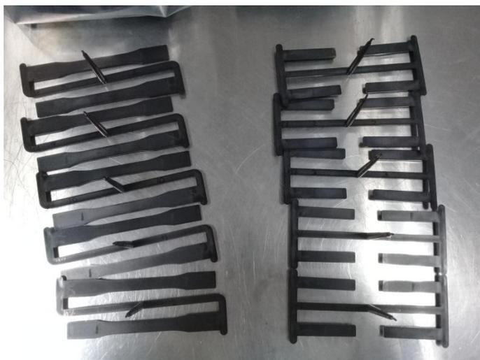
**Figura 25.** Probetas de Tensión e Impacto.
