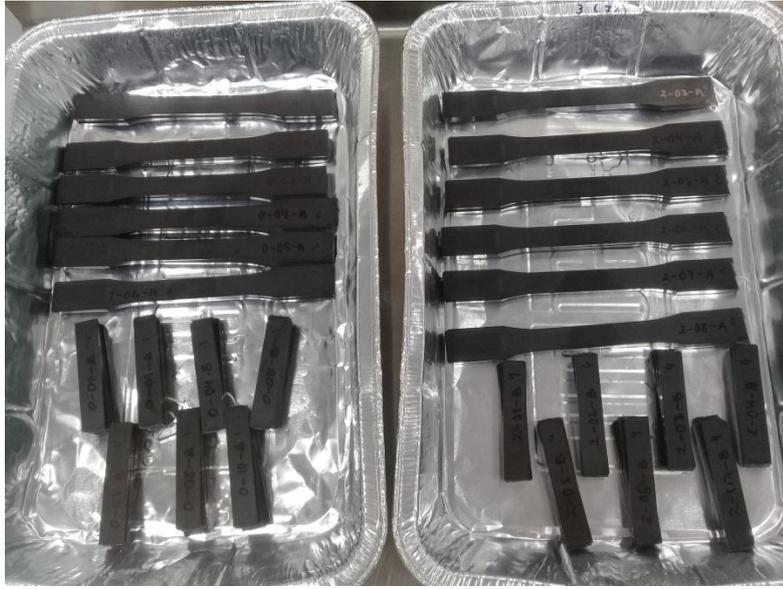
**Figura 27.** Probetas seleccionadas para pruebas fisicomecánicas.
