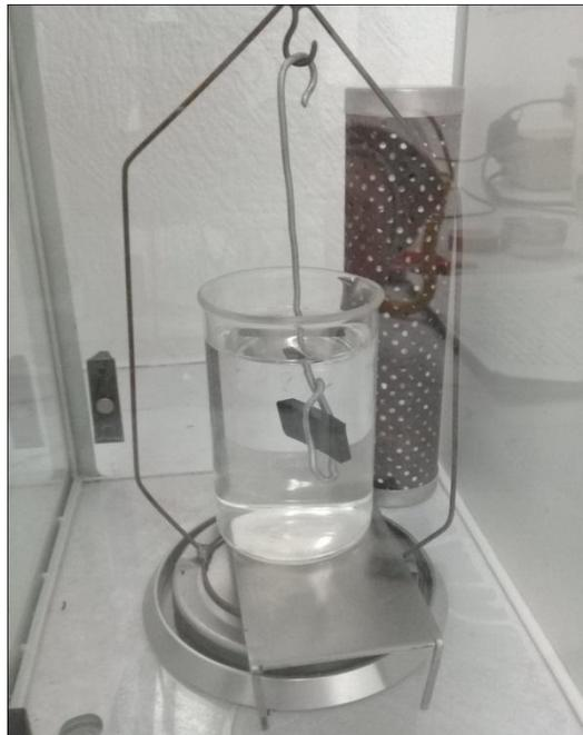
**Figura 34.** Sistema empleado para pruebas de densidad.
