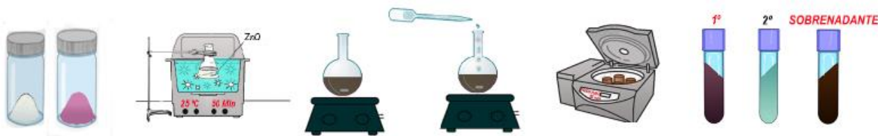
Figura 8. 3 Esquema de la síntesis del funcionalizado nanorodillos-AgNPs
