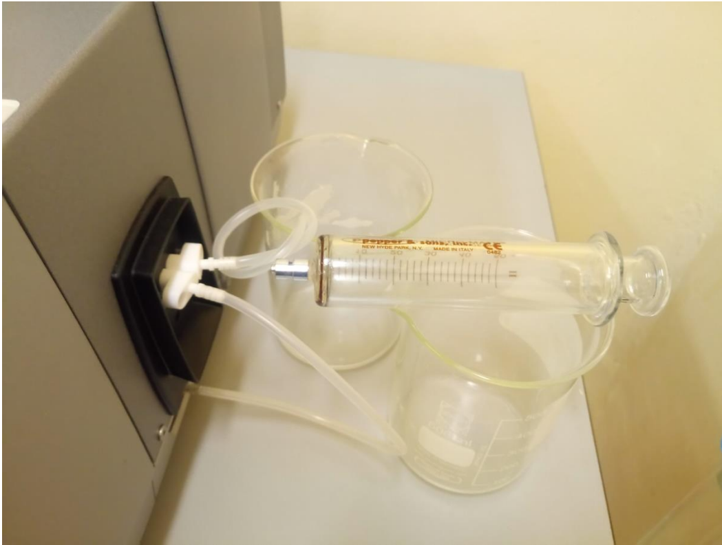
Fig. 27 Mangueras de conexión conectadas correctamente al densímetro tipo oscilatorio
