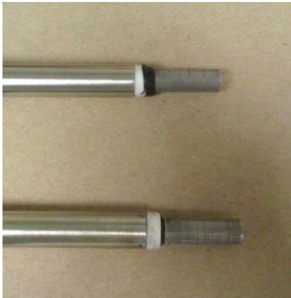
Figura 21. Electrodo de cilindro rotatorio utilizados en las pruebas electroquímicas. Fuente: elaboración propia
