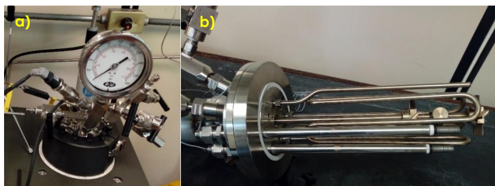
Figura 18. Cabezal del reactor. a) parte exterior del cabezal y b) parte interior del cabezal. Fuente: elaboración propia
