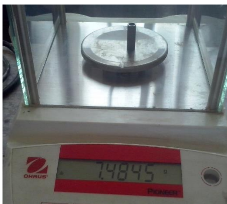
Figura 24. Cupón A antes de las pruebas electroquímicas. Fuente: Elaboración propia
