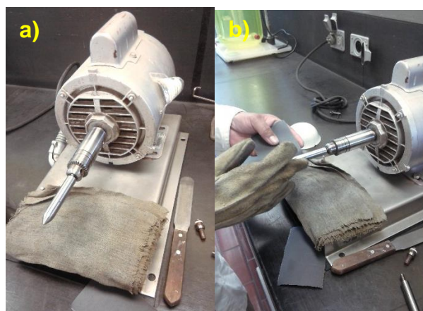
Figura 9. a) Motor monofásico acoplado a un porta-electrodo cilíndrico. b) Proceso de desbaste de un electrodo cilíndrico. Fuente propia.
