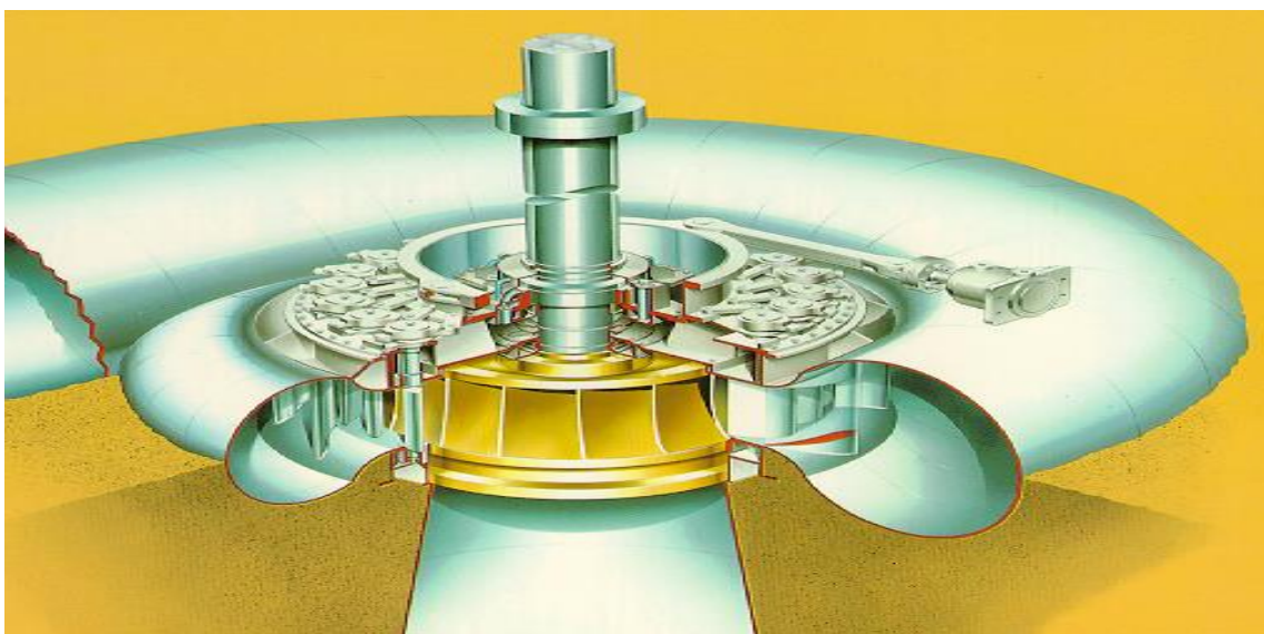
Fig.15.- Carcasa de una turbina tipo Francis.
