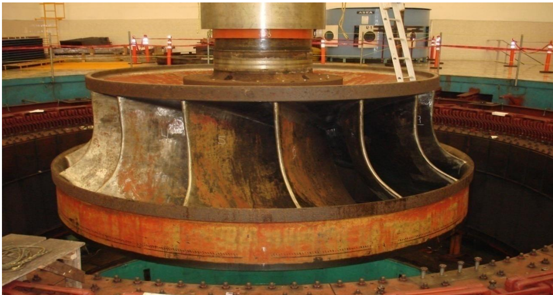
Fig.16.- Rodete de una turbina tipo Francis.
