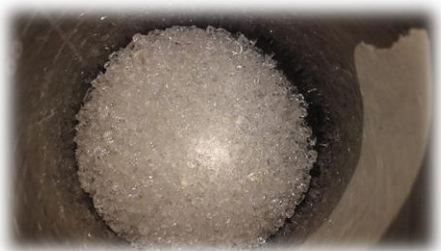
Figura 31 Silica gel utilizada como partícula vehículo (Soporte).
