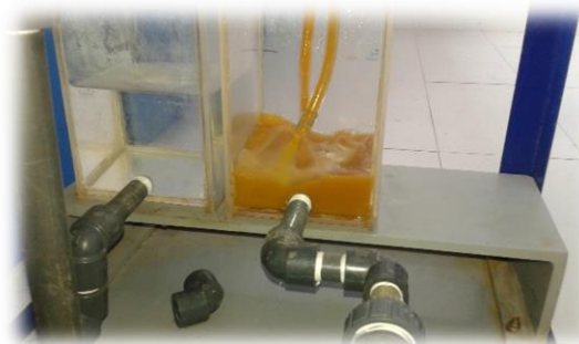
Figura 35 Recirculación de agua en tratamiento Fenton de lecho fluidizado
