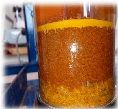
Figura 38 Sedimentación de los lodos sobre el soporte.
