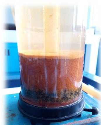
Figura 38.1 Sedimentación de los lodos sobre el soporte.
