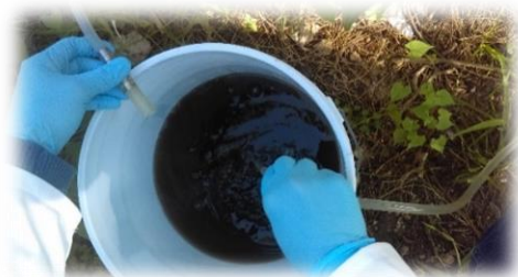
Figura 10 Toma de agua para pruebas Fenton Químico y Fenton de lecho Fluidizado
