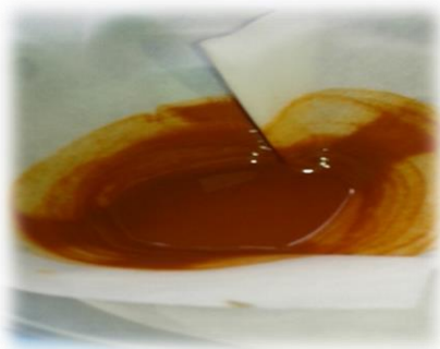
Figura 25 Filtración de los lodos generados en la Neutralización
