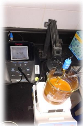
Figura 23 Medición del pH y Neutralización.
