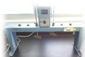
Figura 18 Agitador de jarra HS-4 Mod 7790-100 Phip ps & Bird
