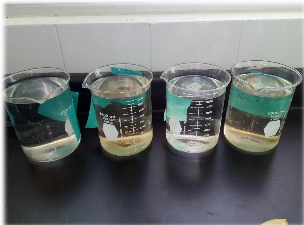
Figura 41 Resultados finales de cada prueba Fenton de lecho fluidizado (tiempo de tratamiento: 5, 10, 15 y 20 minutos)
