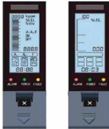
Imagen 11 Indicador de atmósfera explosiva en gasómetro [2]
