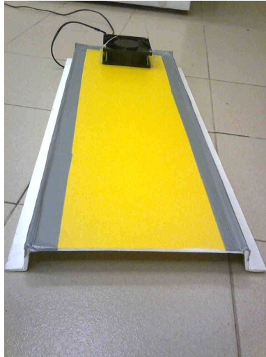
Figura 3.25. Ducto y ventilador acoplados
