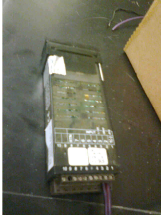
Figura 4.5.-Controlador de temperatura CNI32
