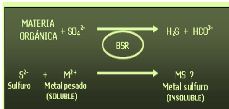
**Figura 8. Reacción de reducción biológica de sulfato y reacción de sulfatos con metales.**
