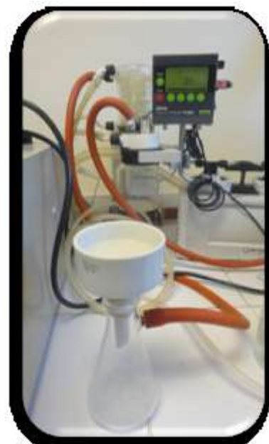
LAVANDO Y FILTRANDO CON BOMBA DE VACIO
