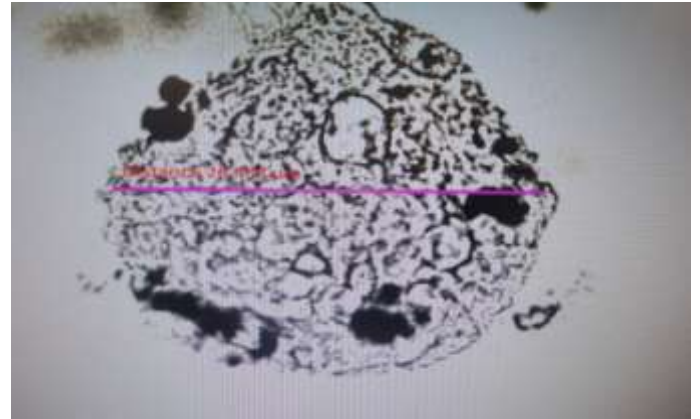
FIGURA 15. MICROCAPSULAS CON EL HOMOGENIZADOR PRO 200 A 5000 RPM , TAMAÑO 26.433 \mu\text{m} A PESO CONSTANTE
