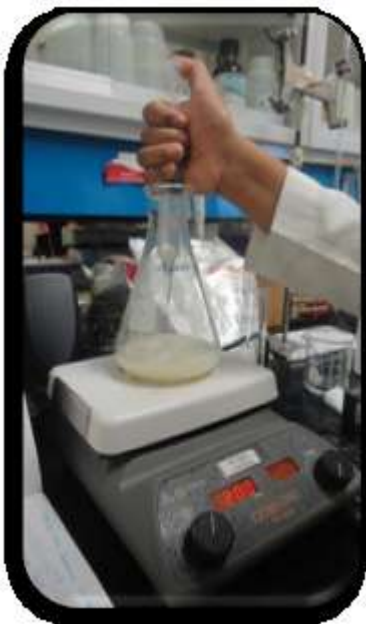
MEZCLANDO A 200 RPM AGITACIÓN MAGNETICA
