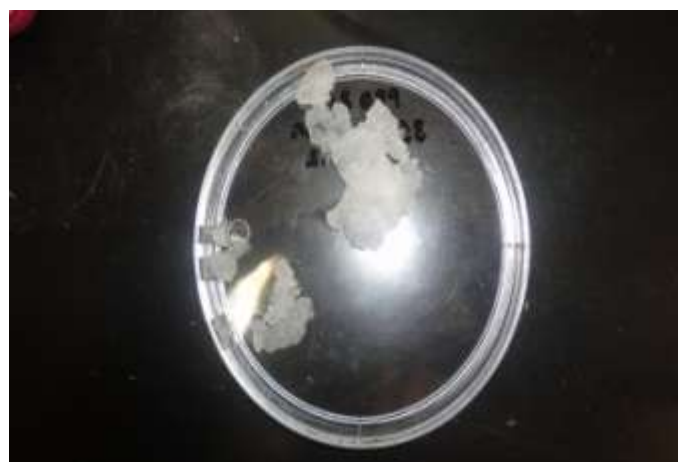
FIGURA 13. MICROCAPSULAS CON EL HOMOGENIZADOR PRO 200 A 35000 RPM A PESO CONSTANTE
