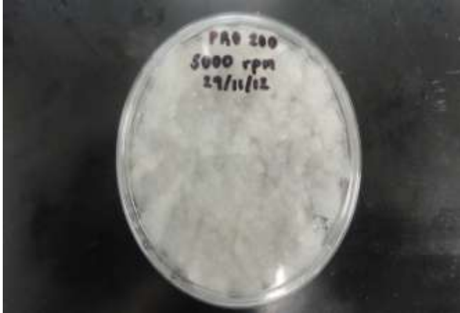
FIGURA 8. MICROCAPSULAS CON EL HOMOGENIZADOR PRO 200 A 5000 RPM
