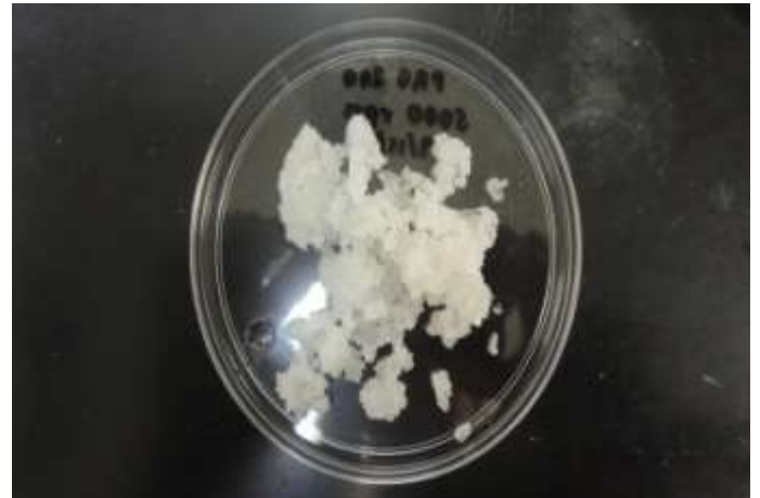
FIGURA 9. MICROCAPSULAS CON EL HOMOGENIZADOR PRO 200 A 5000 RPM A PESO CONSTANTE
