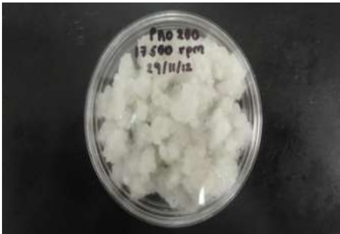
FIGURA 10. MICROCAPSULAS CON EL HOMOGENIZADOR PRO 200 A 17500 RPM
