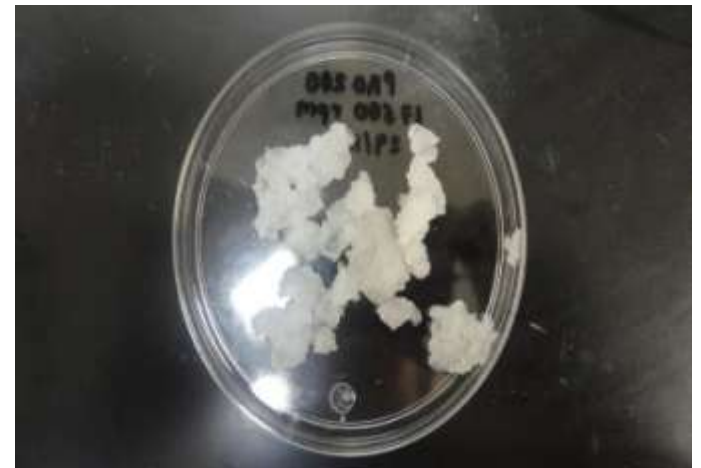
FIGURA 11. MICROCAPSULAS CON EL HOMOGENIZADOR PRO 200 A 17500 RPM A PESO CONSTANTE
