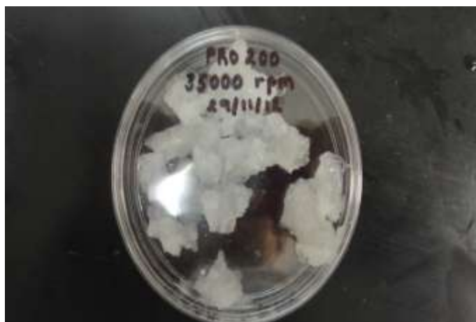
FIGURA 12. MICROCAPSULAS CON EL HOMOGENIZADOR PRO 200 A 35000 RPM
