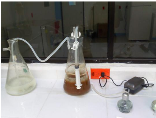
Figura 6. Matraz con Sistema de aireación velocidad de fluio 1vvm.
