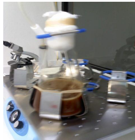
Figura 7. Matraz con Sistema de aireación a 100 rpm.
