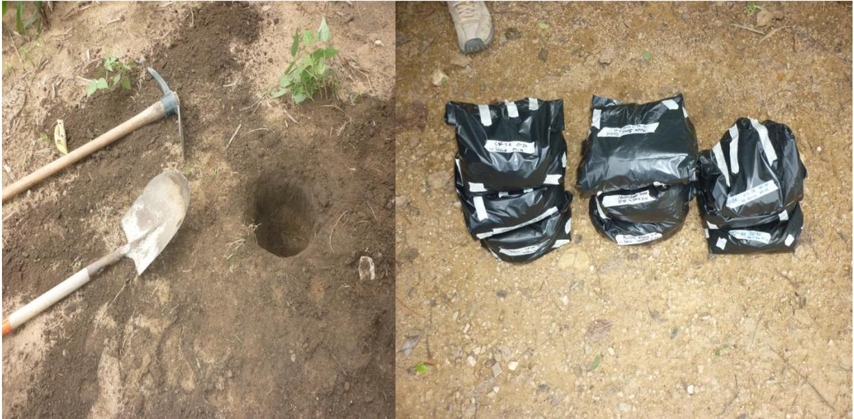
Figura 4. Obtención de las muestras de suelo a cierta profundidad
