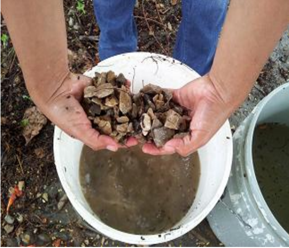
Lavado del medio granular
