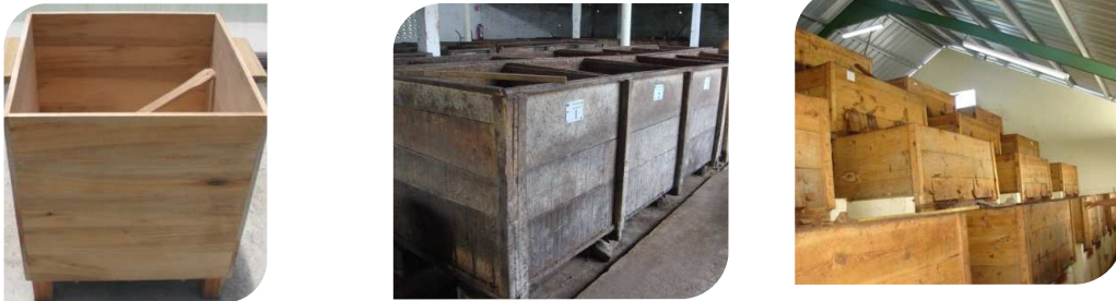
Figura 11. Fermentadores de madera, a) a nivel, b) tipo escalera
