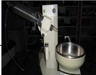
Se recuperó el sobrenadante en un matraz bola (previamente pesado). Se evaporó a vacío con un rotavapor.
