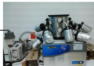
Se liofilizó protegiendo las muestras de la luz, a  $-20^{\circ}\text{C}$  y 0.100psi.
