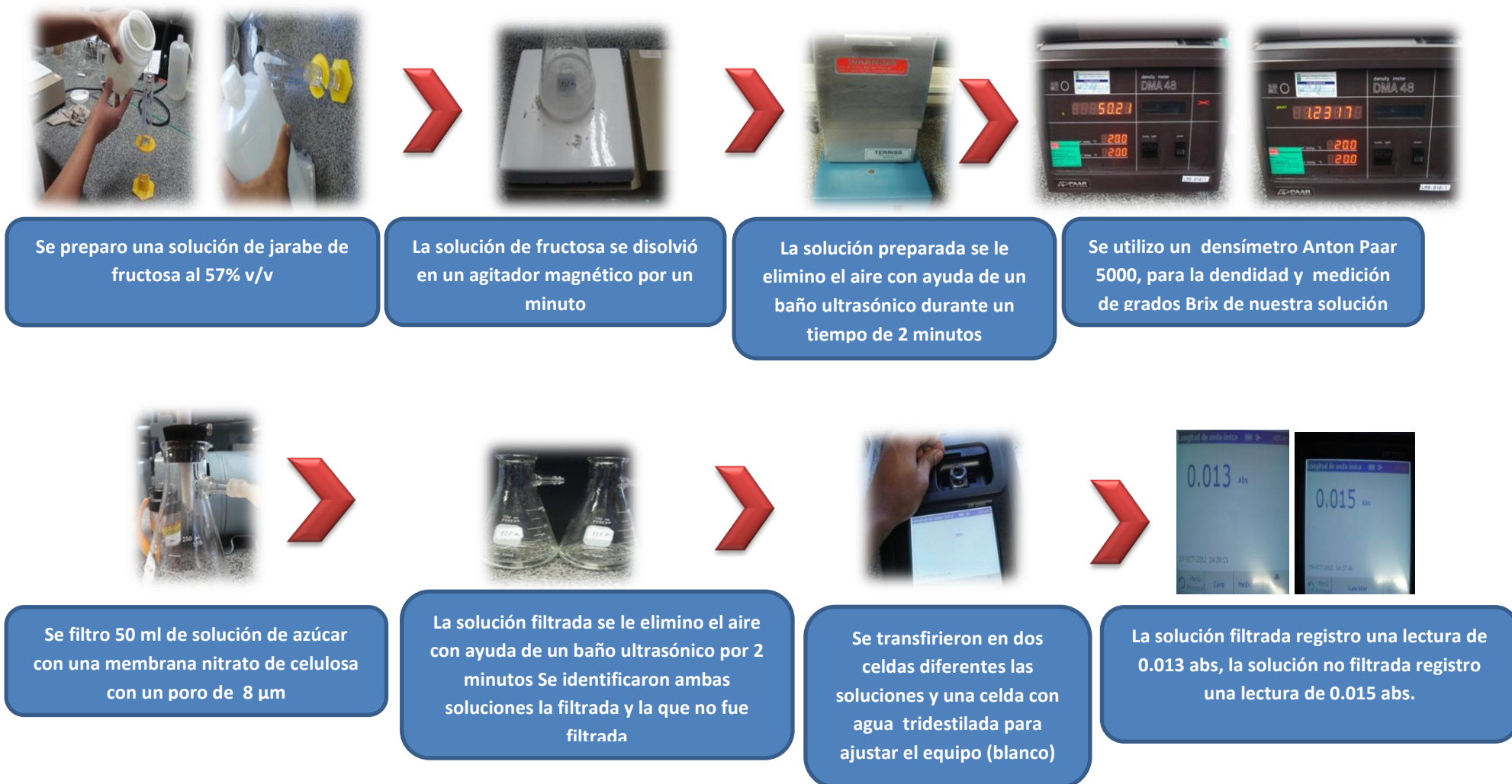
Figura 12. DIAGRAMA DE FLUJO EN LA APLICACIÓN DEL MÉTODO ESTÁNDAR SM-PR-485 EN FRUCTOSA 55
