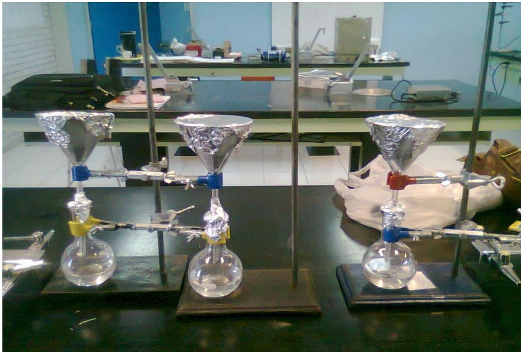
Figura 7. Método de capacidad de retención de agua (CRA)
