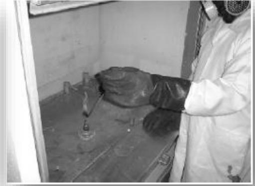
Figura 4. Prueba de laboratorio para inflamabilidad de la muestra de DQO y DBO.
