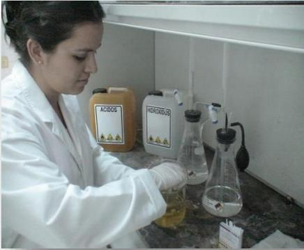
Figura 3. Prueba de laboratorio para corrosividad de la muestra de DQO y DBO.
