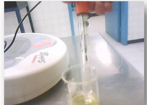
Figura 2. Prueba de laboratorio para corrosividad de la muestra de Fosforo Total.
