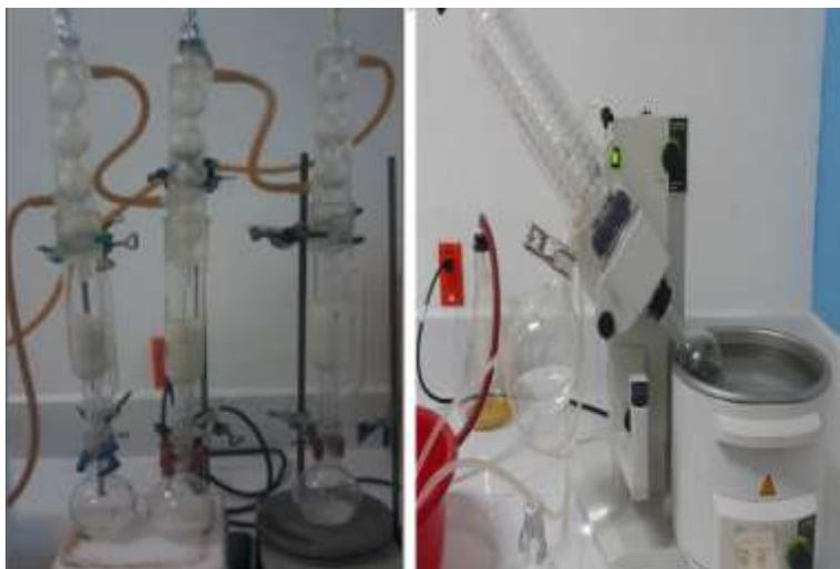
**Figura 8.7** Equipo Soxhlet y Rotavapor
