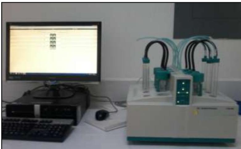
*Figura 8.9* Equipo 873 Biodiesel Rancimat® (Metrohm®).
