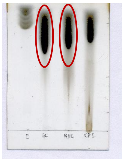
Figura 5. Análisis en cromatografía de capa fina de fructanos del extracto de galleta.
