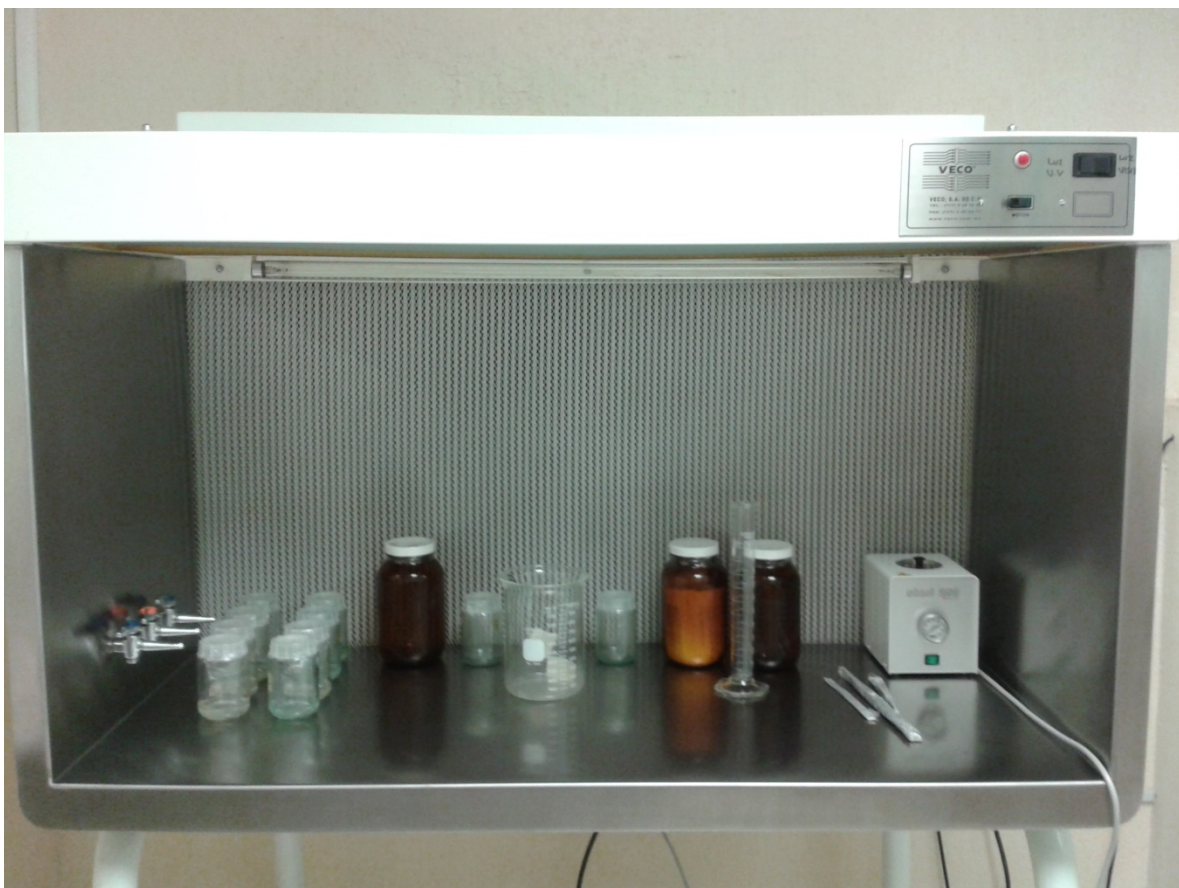
Figura 7. Campana de Flujo laminar y material utilizado para la desinfección de meristemas.
