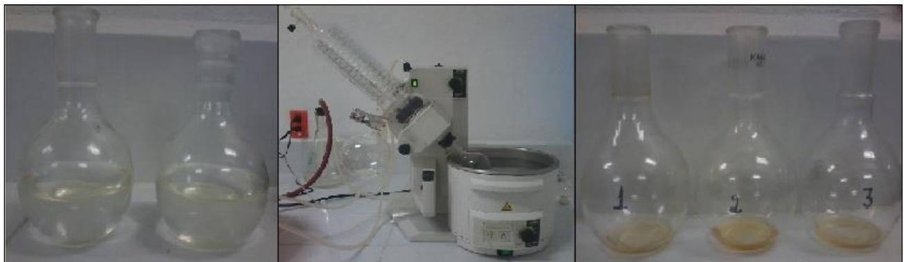
**Figura 8.5.2.** Separación del aceite y solvente por el rotavapor.
