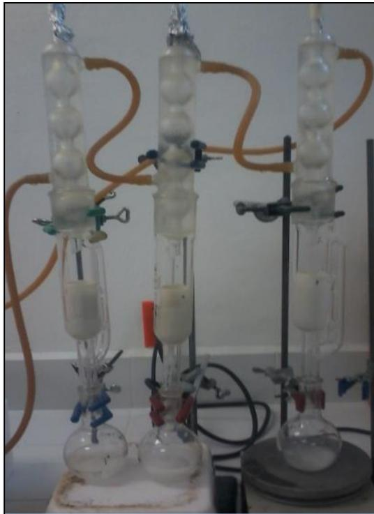
**Figura 8.5.1.** Extracción de aceite por método Soxhlet
