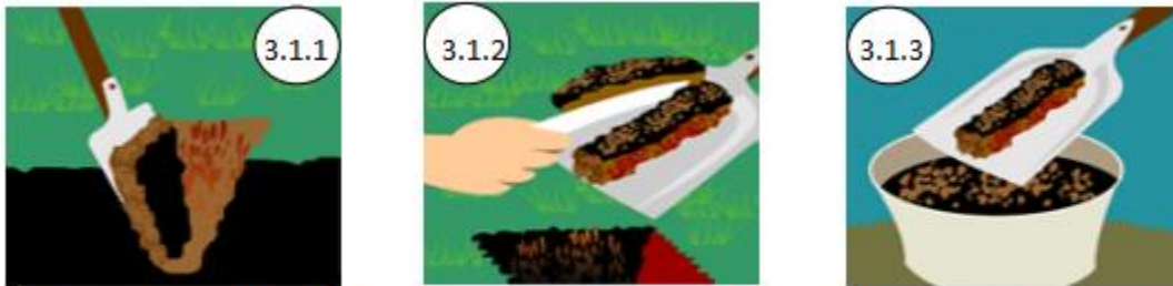
3.1.1) Hueco en "V"; 3.1.2) Corte de muestra de suelo; 3.1.3) Deposito de muestra
