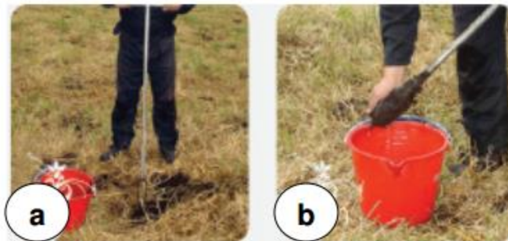
Figura 9.- a) Muestreo con barreno holandés; b) Deposito de muestra
