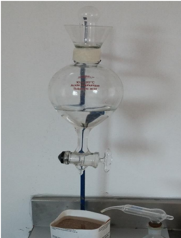
Fig.11 Ácido sulfúrico al 6% prueba de presencia de peróxido de hidrogeno
