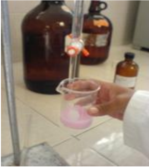
Fig. 10 hidroxido de sodio prueba de acidez
