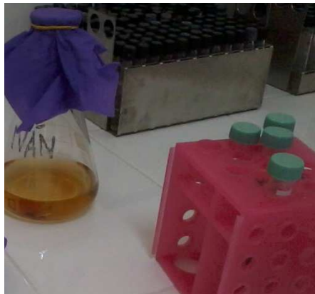
Fig. 15 Depositar 0.95 gr de suelo en tubos falcón con 7.5 ml de medio de cultivo.
