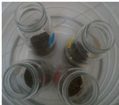
Fig. 13 incubación de las muestras a 25°C por 7 días en un ambiente fresco
