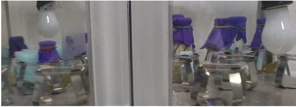
Fig. 17. incubación de los matraces a 22°C por 100 rpm por 7 días.
