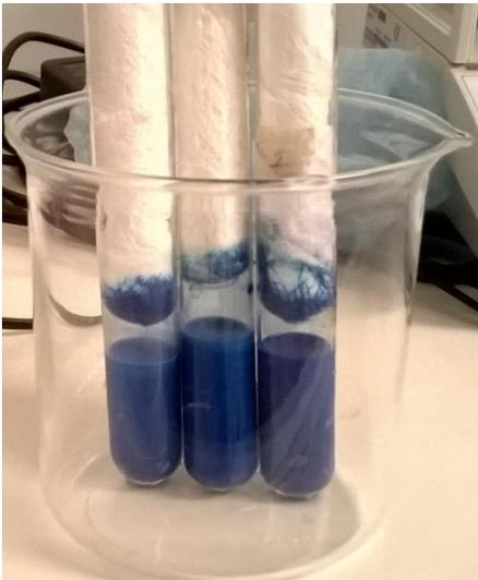
Figura 8. Resultado de los triplicados de la prueba de reductasa.
