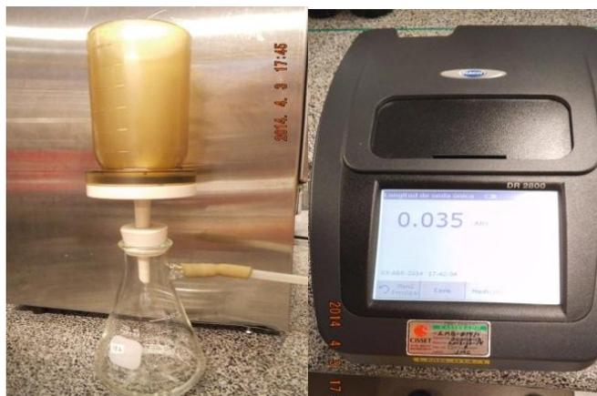
**Figura 12.** Medición de absorbancia en Jarabe de Azúcar refinada ya filtrado en espectrofotómetro digital.
