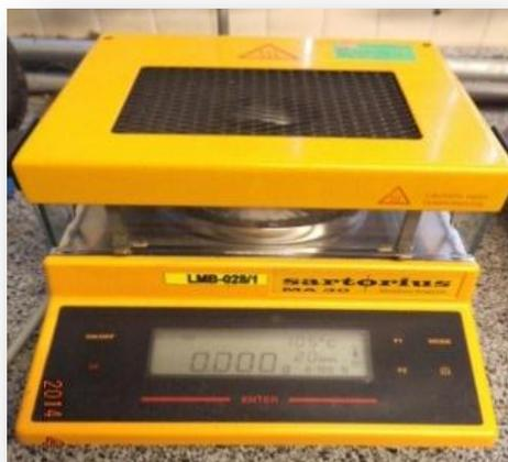
**Figura 13.** Medición de % Humedad en Azúcar en Termobalanza.
