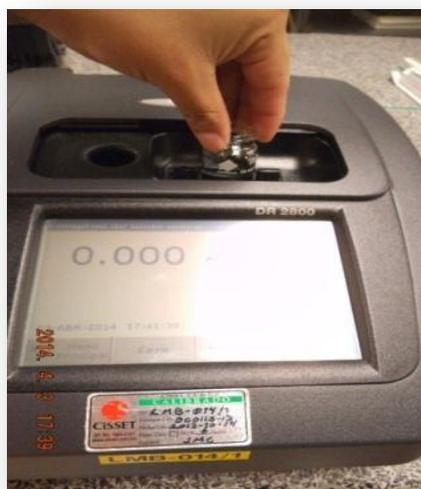
**Figura 11.** Medición de absorbancia en Jarabe de Azúcar refinado en espectrofotómetro digital.
