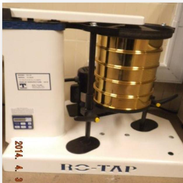
**Figura 14.** Análisis de % de malla en Azúcar Refinada utilizando agitador Ro-Tap.
