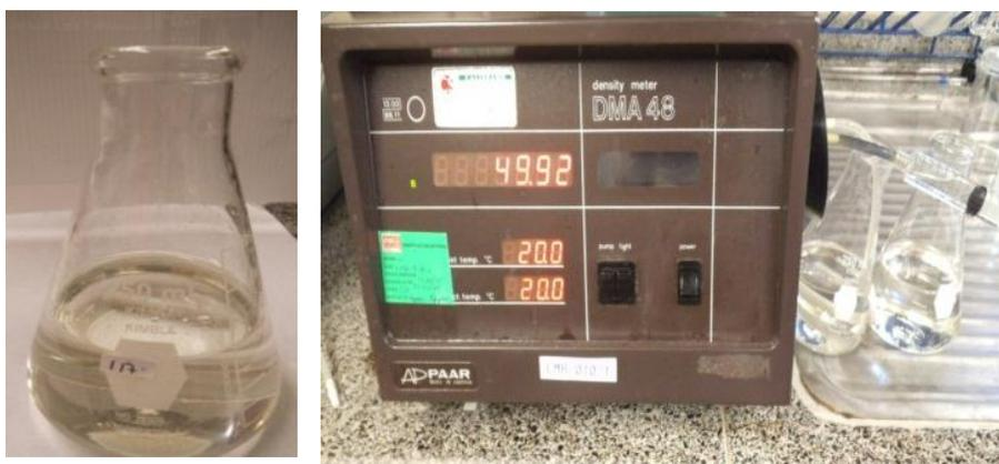
**Figura 10.** Medición de °Brix en Jarabe de Azúcar refinada en densímetro.
