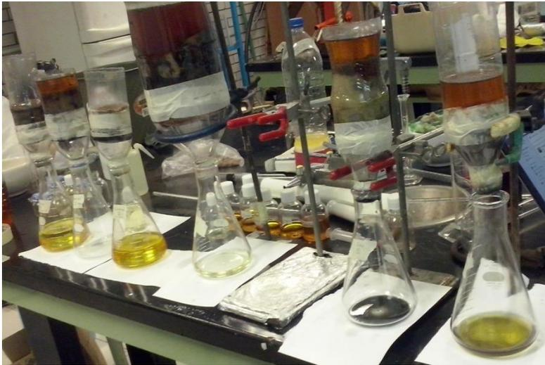
**Figura 12.** Columnas empacadas con los 5 adsorbentes seleccionados.
