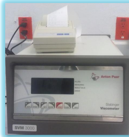
Figura No 8: Viscosímetro SVM 3000® (Anton Paar®)
